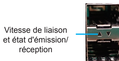
Figure 4. Voyants du port Ethernet SFP
